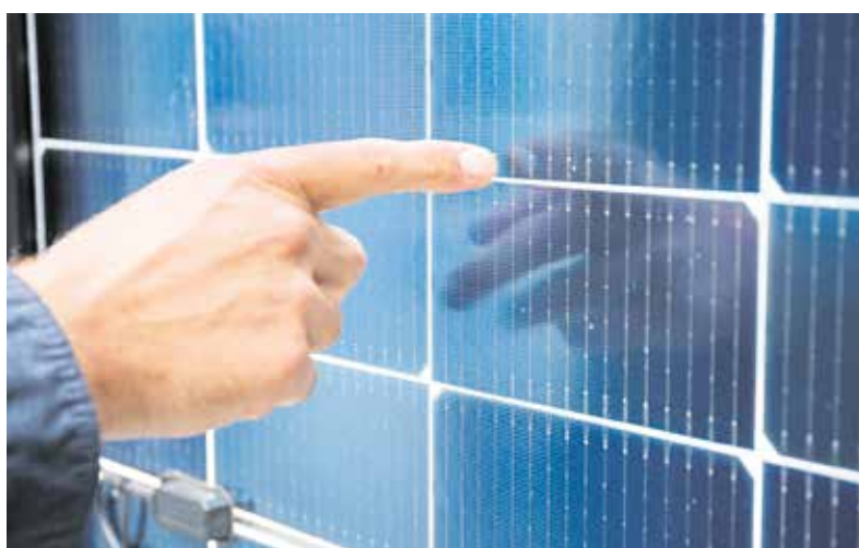
Die bifazialen PV-Module können Sonnenstrahlen von beiden Seiten aufnehmen.
